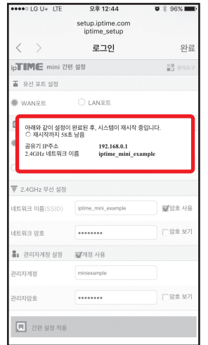
설정된 공유기 IP주소, 2.4GHz 네트워크 이름이 표시됩니다. 설정이 완료되면, 자동으로 [Wi-Fi] 설정화면으로 돌아갑니다.
